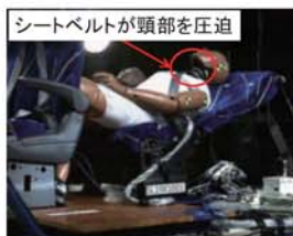
図5 シートバック角度80°、3点式シートベルト条件のダミーの状態 (110 ms)
