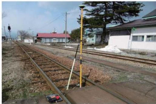
図4 踏切端点（定点）での高精度測位の様子
