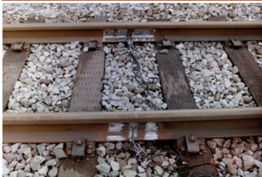
曲線部地上側輪重・横圧の測定
