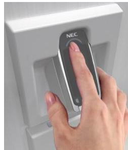
生体認証設備
