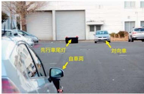
図2 自車両側から見た実験装置の様子
