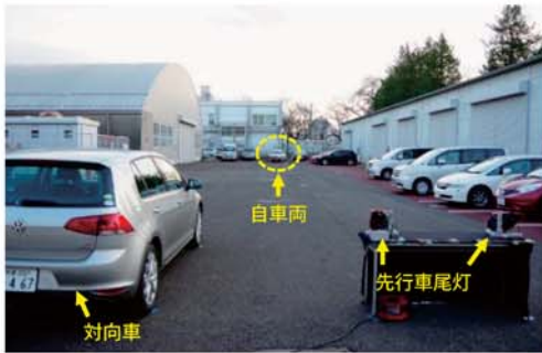
図3 対向車側から見た実験装置の様子
