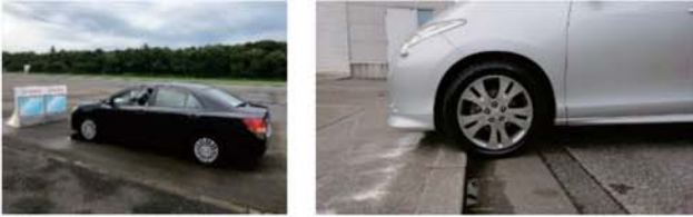
図 3 前方に壁 (左) と段差の乗り越え (右)
